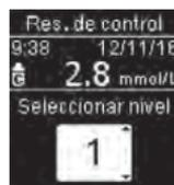
Aparecen **Res. de control** y el símbolo del frasco de solución de control. Pulse  $\blacktriangleleft$  o  $\blacktriangleright$  para seleccionar el nivel de control que ha utilizado. Si no selecciona ningún nivel, el resultado de control se guarda sin nivel de control. Pulse **OK**.
