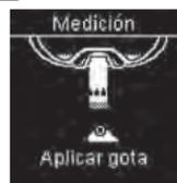
Cuando aparezca **Aplicar gota**, efectúe una punción en la yema del dedo con el dispositivo de punción.
