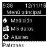
Encienda el medidor pulsando brevemente **OK**. En el **Menú principal** pulse **▼** para resaltar la opción de la función Patrones en la parte inferior de la pantalla (**Patrones** en el ejemplo). Pulse **OK**.
